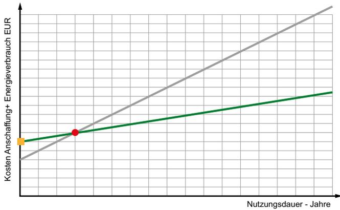
Grundlage für diese prinzipielle Darstellung sind Berechnungen des Energieverbrauchs des Trafos, bei konstanten Energiekosten von 13,4 ct/kWh (Quelle: first energy) über 16 Jahre. Bandbreiten ergeben sich durch die unterschiedlichen Trafoleistungen.
