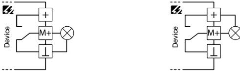
Low-Aktiv: Im aktiven Modus wird das Potential GND auf den Ausgang M+ geschaltet.
