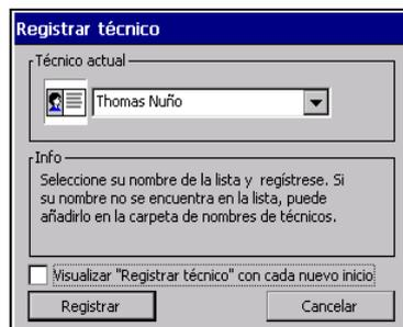
Si trabajan varias personas con el sistema de prueba, existe el riesgo de que se olvide seleccionar el nuevo nombre de comprobador. Para evitarlo, active el botón  "Registrar técnico" con cada nuevo inicio. Después de cada conexión del sistema de prueba aparece entonces la ventana "Registrar técnico".
