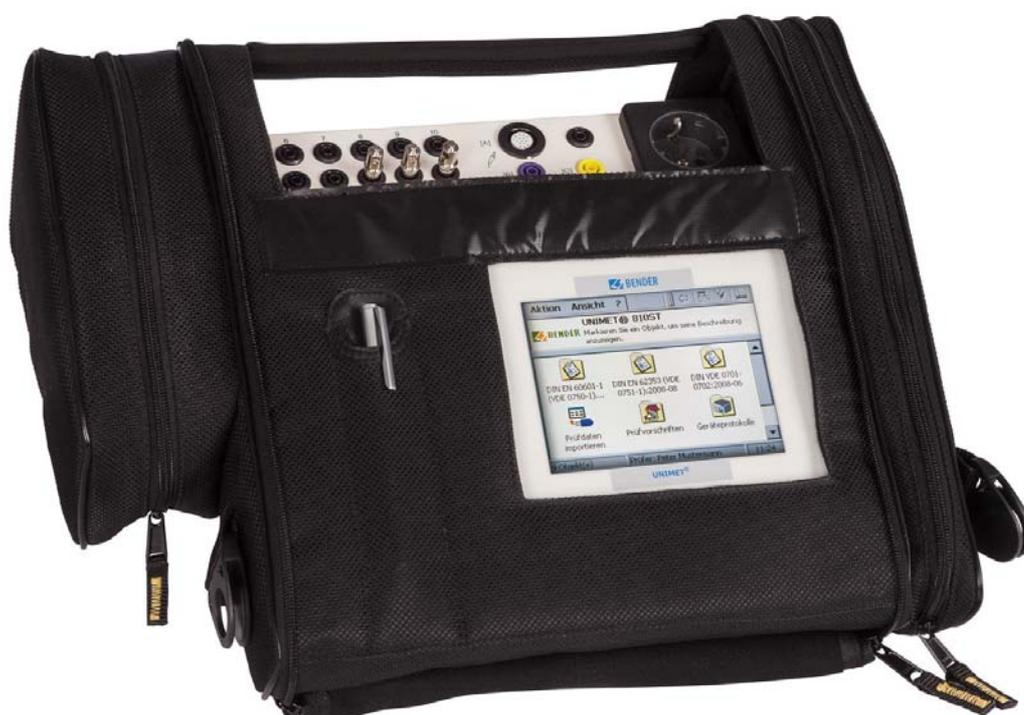
**Sistema de prueba para la seguridad eléctrica**
